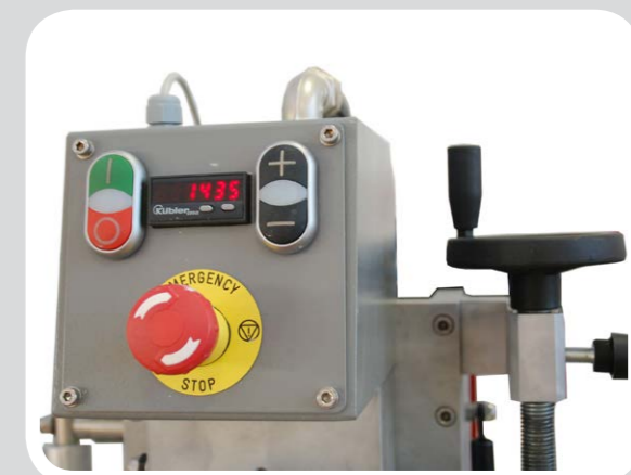
▲ Pannello di controllo (comandi in bassa tensione 24 V AC)
