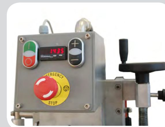
▲ Panneau de contrôle (commandes à basse tension 24 V CA)
