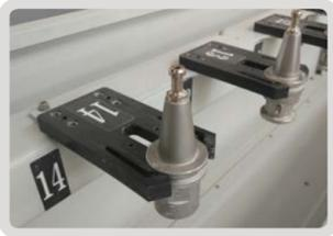
**Automatischer Werkzeugwechsel, Werkzeugmagazin mit 20 Positionen**
